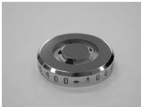
ナノインデンテーション用超微小硬さ基準片 約430HV (外径 25mm、中央部の9mmがタングステン単結晶)
