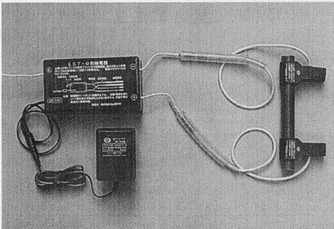
静電気の帯電を除電する無公害の電圧印加式除電器。低電力の圧電トランスにより昇圧して得られた高圧を印加した電極を絶縁化し、帯電した物体に対向させるだけで、コロナ放電などを一切起こさず、静電気を中和できる。
