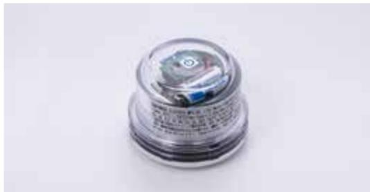
防爆Wi-Fi振動センサー「コナンエア」は、第一類危険箇所（ゾーン1）にある汎用回転機械や搬送設備の外側に磁石で設置できる加速度や速度を測るセンサー。検出した生データをWi-FiでPCやスマートフォンに送信する。データから異常発生を予測でき、予防保全に役立つ。
