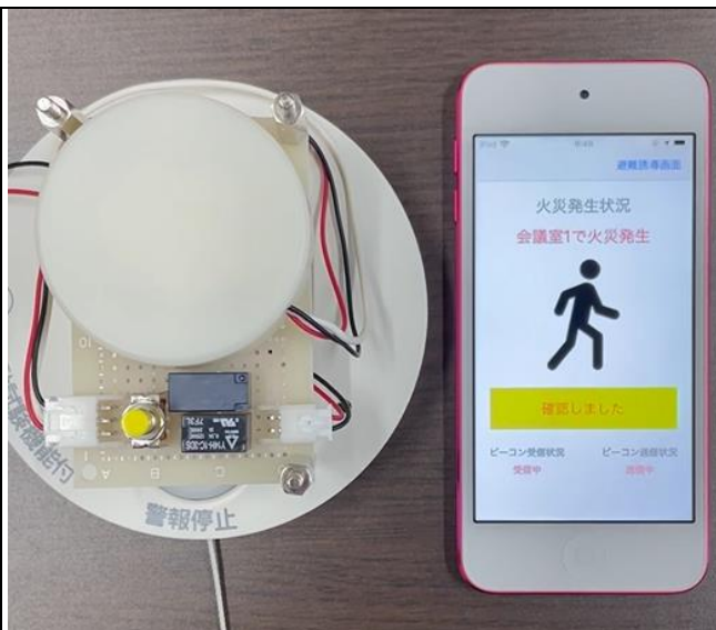
火災報知器（ビーコン一体型）
