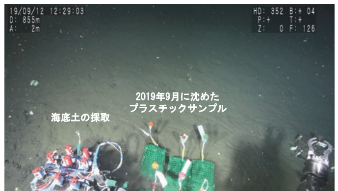
図5 NEDO先導研究プログラム (「様々な生分解性プラスチックの海洋分解性評価: 代表岩田忠久」) で、2019年9月12日に初島沖の深海850mに設置した生分解性プラスチックの写真 (共同研究先・JAMSTEC 提供)
