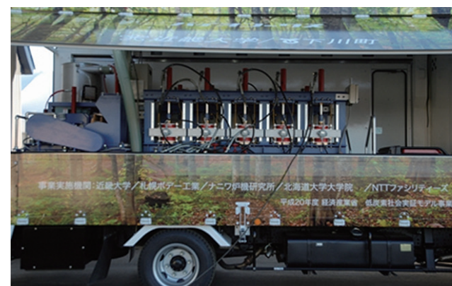
【写真2 モバイル型バイオコークス製造装置搭載トラック】
