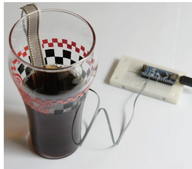
図6 ラミネートコーティングによる防水加工 (水深センサの例) [1]
