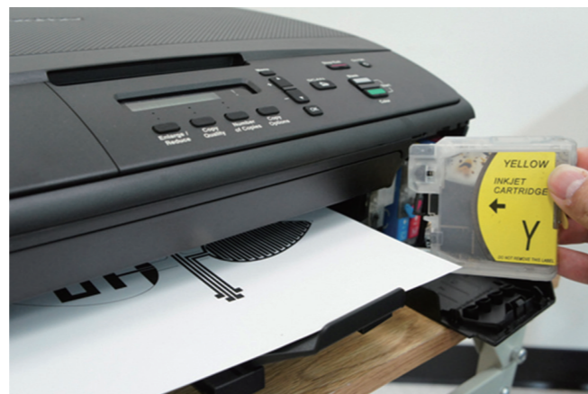
図2 プリンタで印刷実装した電子回路基板[1]。基板データはインターネットで公開しているものをそのまま利用可能。
