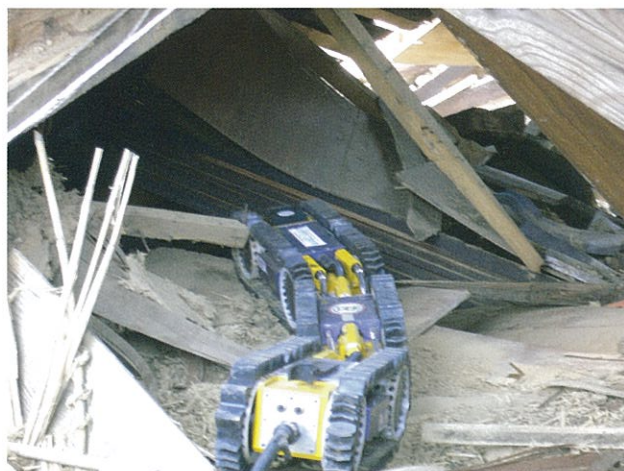
図5 瓦礫内探査用ヘビ型ロボット (国際レスキューシステム研究機構、東京工業大学: 広瀬G)
