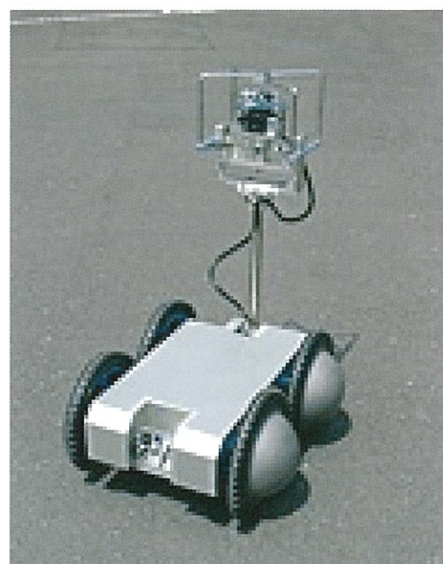
図4 地下街移動ロボット (電気通信大学: 松野G)
